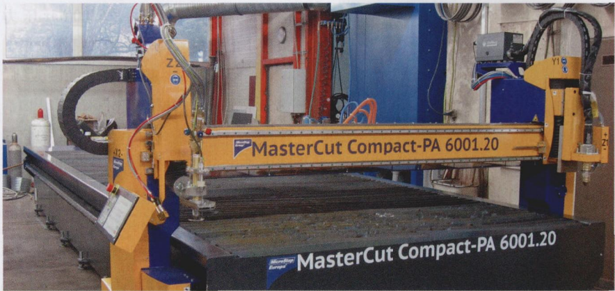
图 2 Aigeldinger 公司所使用的 Mastercut 等离子切割设备是为中小型企业的需求专门设计的
