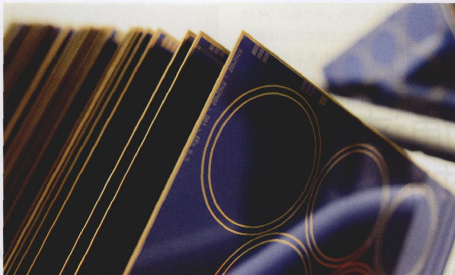
图4为采用腐蚀加工方法进行加工做好准备的分层，并印上纹理的材料薄板
