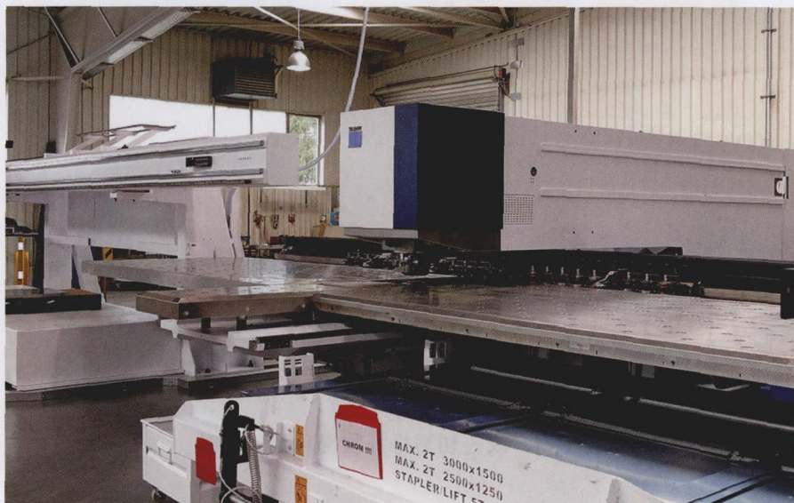
图2 Trupunch 5000 型冲压机床目前是世界上最快的冲压机床。并为使用者提供有选择“主动低模”的可能性，采用该冲压机床加工的工件无划痕
