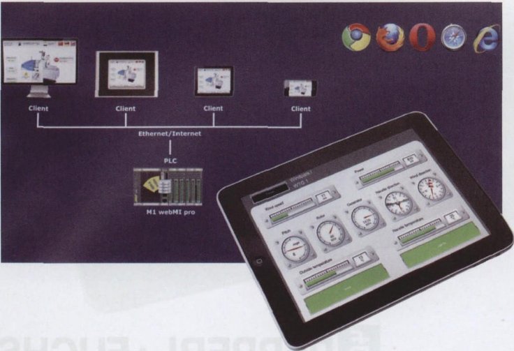
图 3 仅采用网络技术便可监控风力发电设备的动力运行装置
