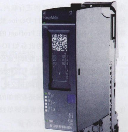
图 4 ET 200 SP 控制装置的能源检测计量模块作为排列在分散式设备中模块，能够以简单的方式集成到一个能源数据检测装置中
