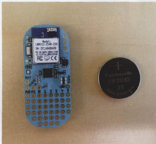
图2 这个蓝牙低能量输入 / 输出模块是一款典型的电子设备，可将几乎任何一部制造设备的小型、低成本传感器装置连接到工业物联网。该模块的供电电池小于二角五分的白铜币，并可续航两年
