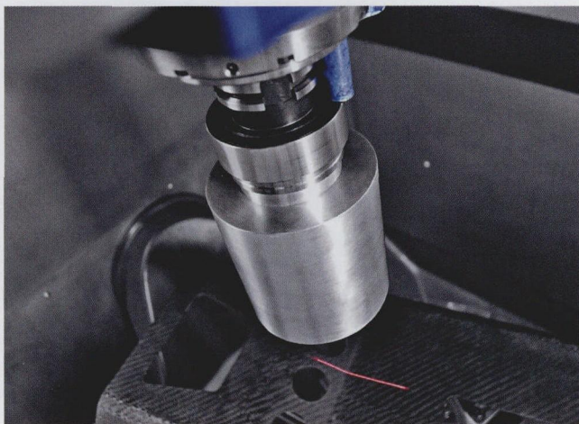
图4 DMG MORI 公司在 Ultrasonic 技术方案中加入了一些专用型技术功能, 例如表面激光反馈和表面激光测量技术
