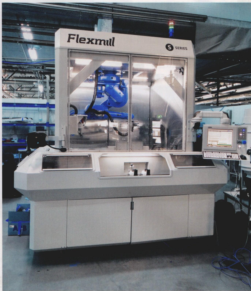
图 1 Flexmill S 系列平台的配置旨在自动加工处理喷气发动机的涡轮叶片。为实施金属切削，架空式 ABB 640 型机器人对着磨料刷轮或铣刀移动叶片
