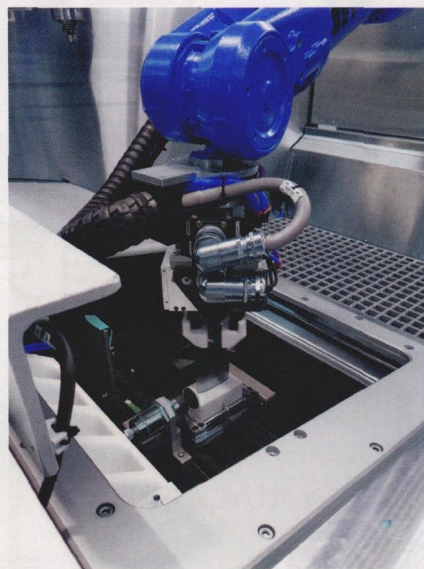
图3 机器人将成品叶片返回地板下的零件棧动托盘。在同一个托盘中承载下一个待加工的叶片
