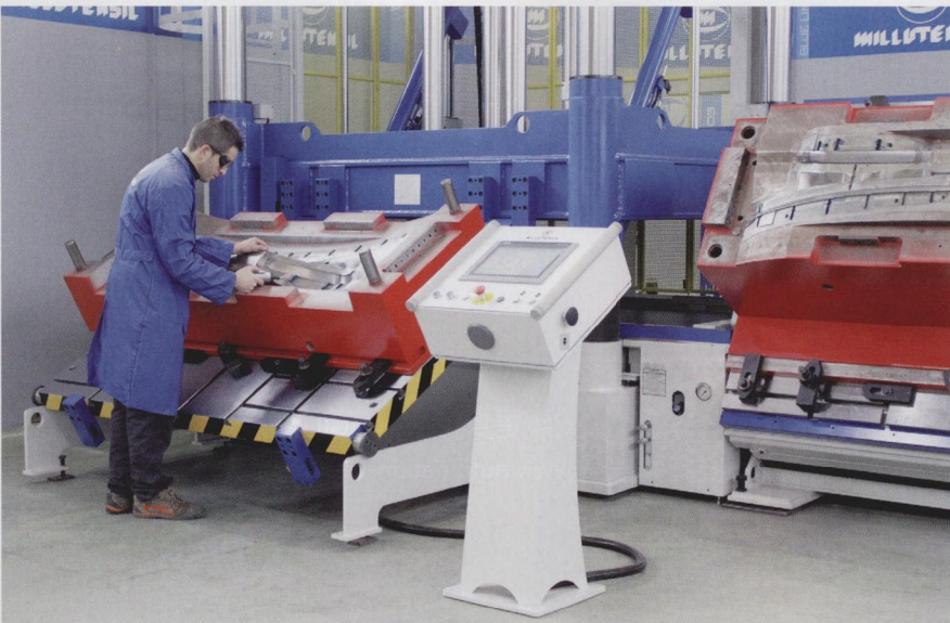
图1 高密度压力机的整修冲模操作通过使得压力机功能更加清晰、直白或者简单的控制触控面板的方式对其进行直观的控制
