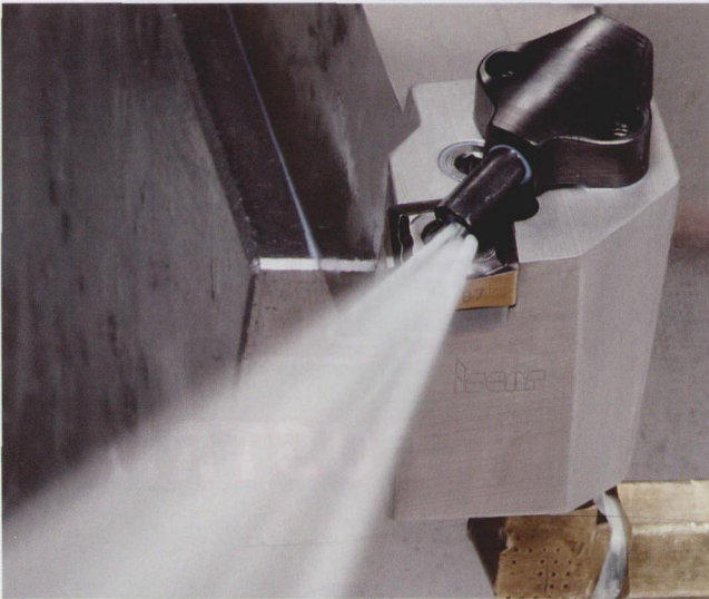
图4 冷却喷嘴嵌于支架中，根据刀具加工方向可对其左右方向进行小幅调整。更换刀片时无需取下支架，缩短了停机时间
