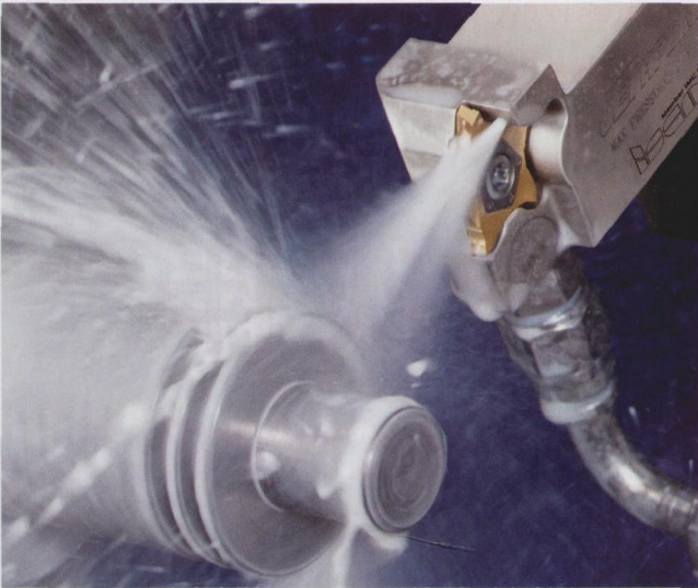
图3 可靠的立装夹持方式保障了出色的稳定性，冷却喷口与切削刀的距离非常短，确保了冷却射流持续高效地直达切削刀
