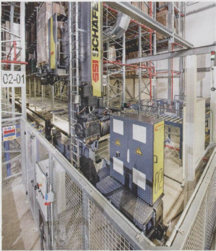
图 5 根据托盘类型，作为单杆设备安装的 Exyz-RBG 使用伸缩臂取货装置进行单层至三层的入库和出库操作
