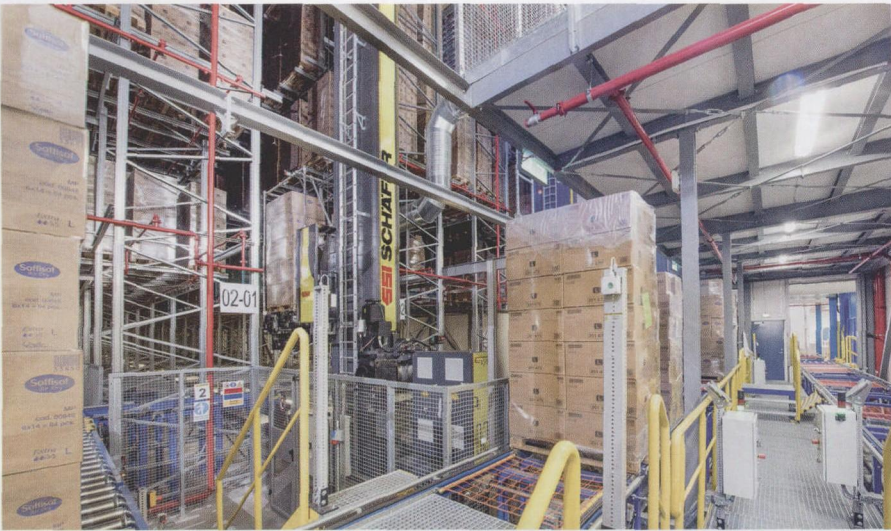
图 4 在高货架仓库（HRL）的传送位置上，安装的 Exyz-RBG 抓具抓取托盘进行入库
