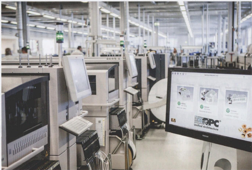
图 5 贝加莱 APROL 过程控制系统可以实时发送参数，如整体设备效率（OEE）
