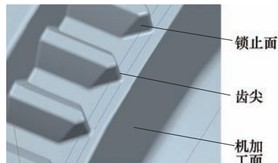
图2 接合齿齿部立体示意图
