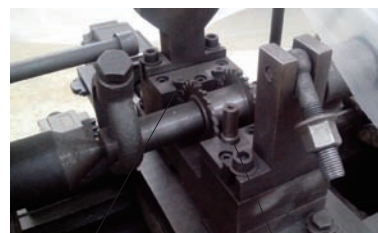
\phi 17.95\text{mm} 菱形销 \phi 17.95\text{mm} 和 \phi 13.1\text{mm} 的阶梯圆形销
