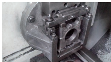
瓦盖大小销孔的方向对应夹具大小定位销才能装夹
