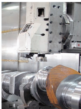
图4 刀架旋转刀具加工曲轴
