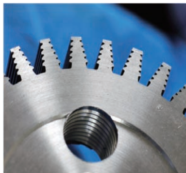
图6 螺纹加工试验件
