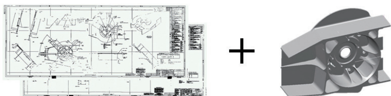
图14 二维图样加实体模型的数字化定义产品
