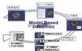
图28 787 MBD用于工艺和工装设计
