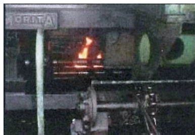
汽车扭杆弹簧滚动校直淬火图
