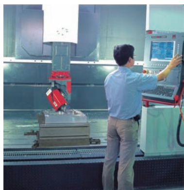
图2 五轴加工中心
