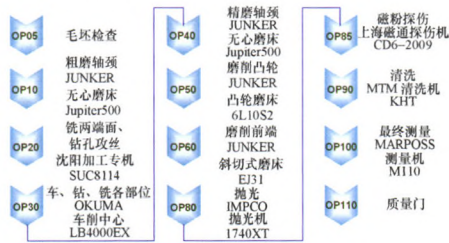
图2 NSE凸轮轴生产工艺流程
