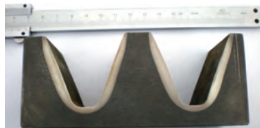
图1 M20齿轮的淬火层分布
