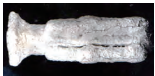
图2 型壳表面裂纹
