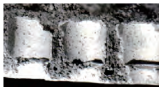
图7 型腔内，均在蜡膜的上部产生蚁孔
