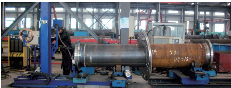
图2 DBH90钢管-法兰埋弧焊接生产线
