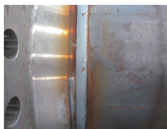
图4 中等口径钢管与法兰对接焊缝
