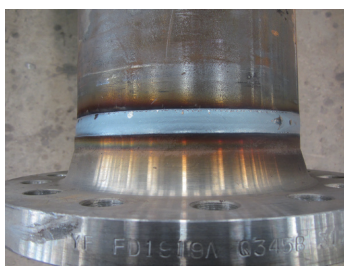
图3 小口径钢管与法兰对接焊缝
