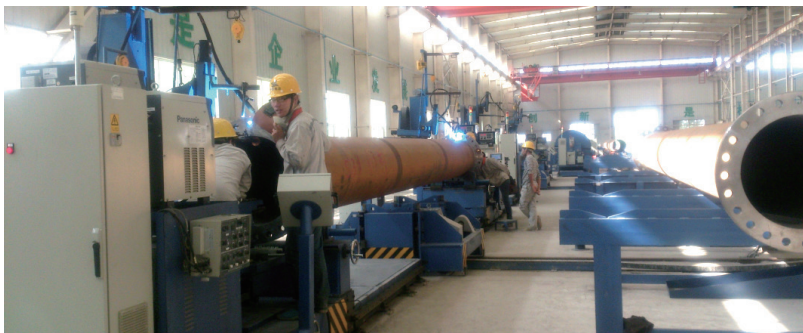
图1 PLH3—1000钢管-法兰熔化极气体保护焊接生产线
