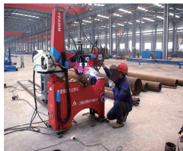
图10 钢管环缝焊接专机
