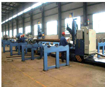
图9 法兰组焊生产线
