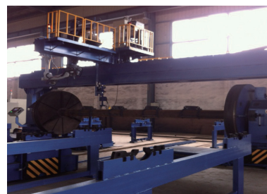
图6 连板焊接机器人系统
