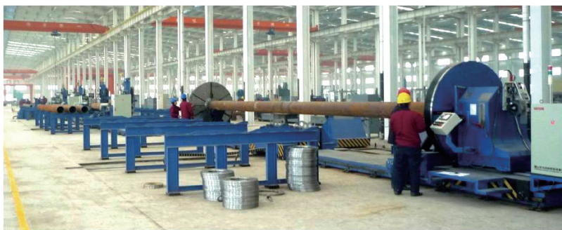
图3 管法兰组对焊接生产线
