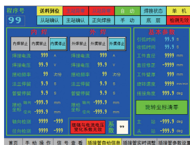
图4 管法兰焊接机自动操作画面
