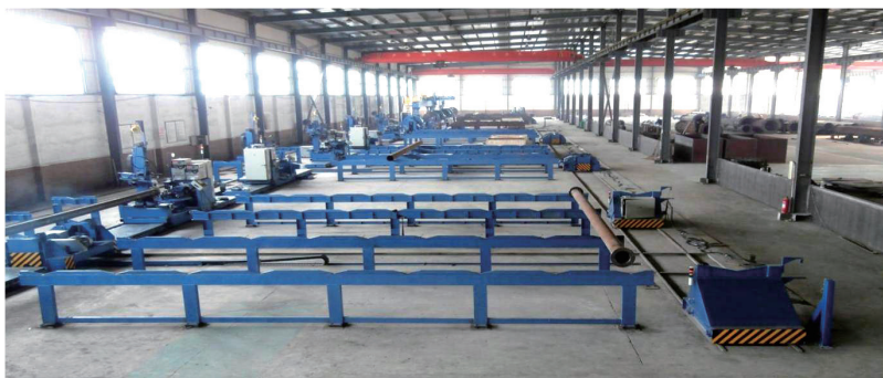
图1 某用户车间全自动焊切设备生产线
