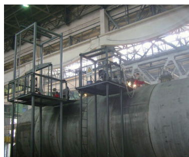
图2 筒体双机组同时焊接环缝
