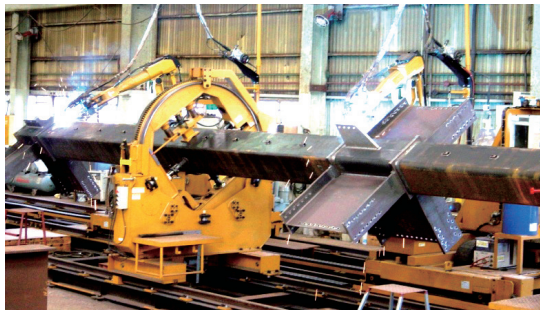
图1 唐山松下摇臂式机器人及辅机
