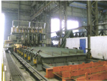
图4 底板单元液压压紧装置反变形胎架
