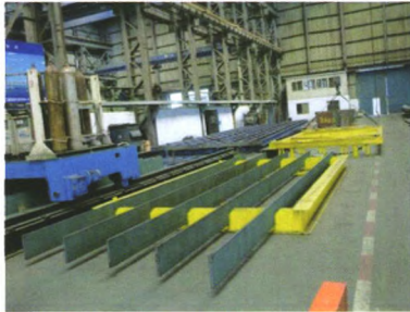
图2 板肋采用专用工装进行吊装
