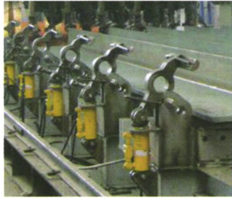
图5 反变形胎架液压装置
