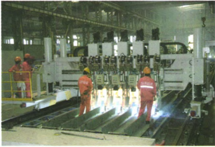
图3 板肋自动装配机装配定位焊
