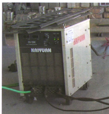
图2 单电源双细丝埋弧焊设备
