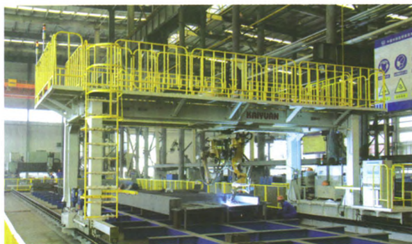
图3 横隔板焊接机器人系统
