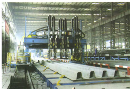
(a) 龙门式多电极焊接设备
