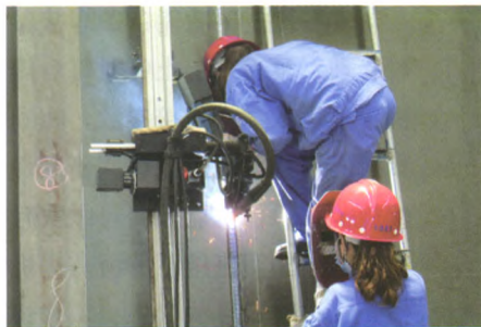
图4 数字化焊接机器人系统
