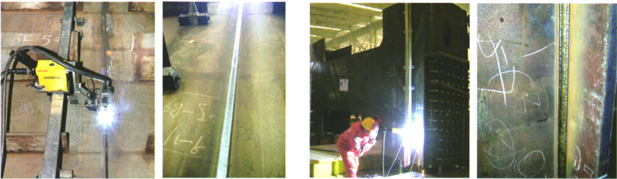
图2 斜底板爬坡焊
