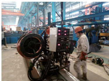
图3 弧形小车埋弧焊
