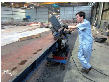
图4 机械加工坡口
