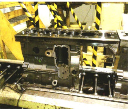
图1 压板珩磨示意图
