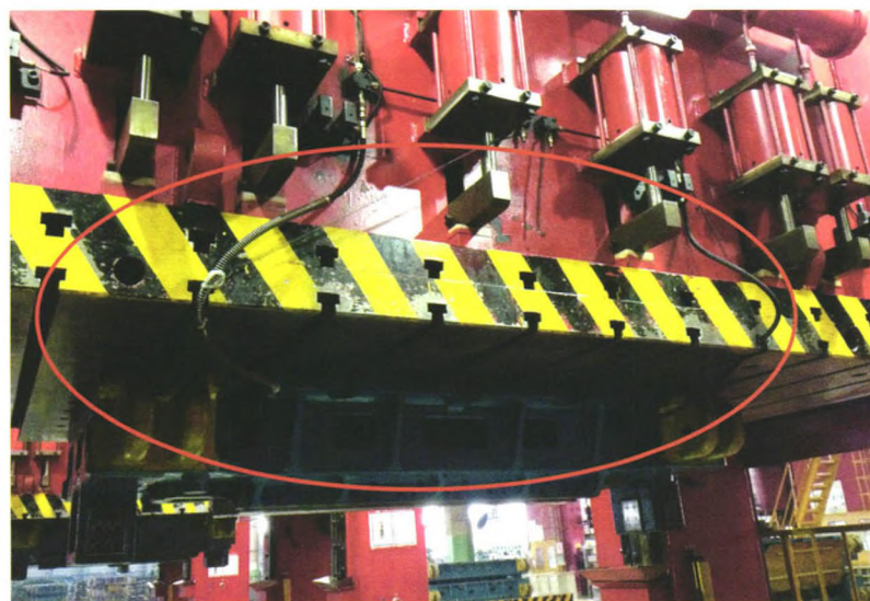
图2 改造后增加夹紧器实现模具自动夹紧
