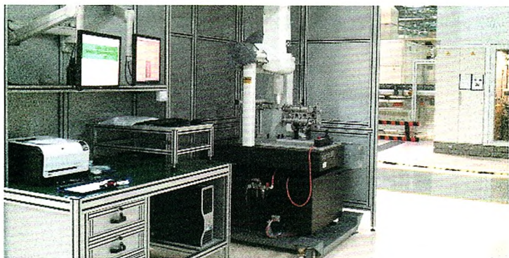
图5 适合车间环境的半开放式坐标测量机的应用实例
