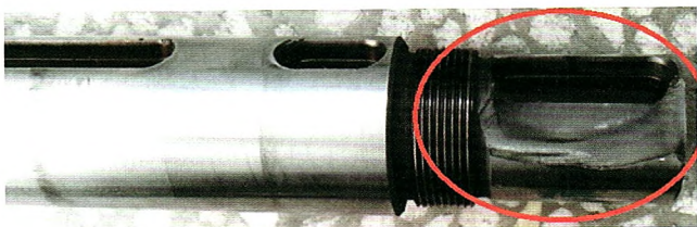
图2 故障刀杆小头端键槽底部剥裂
