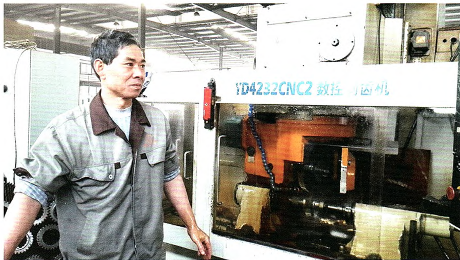
采用CBN砂轮在国产数控剃齿机上珩齿
