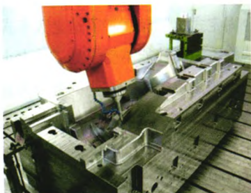
图2 五轴加工汽车仪表板注塑件模具
