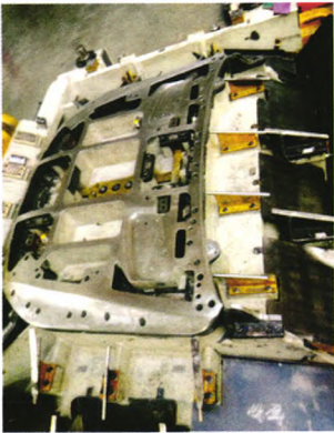
图3 机盖外板下模废料分离修边工艺
