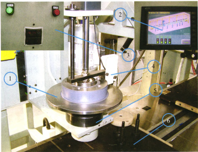
检测防错装置结构示意图
