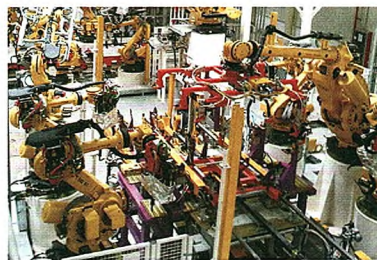
图4 通用分总成柔性焊接工位的标准构成
