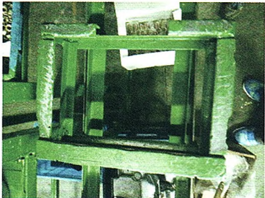
(e) 在原工作台上增加PLC板，避免上盖壳体与工作台硬碰硬
