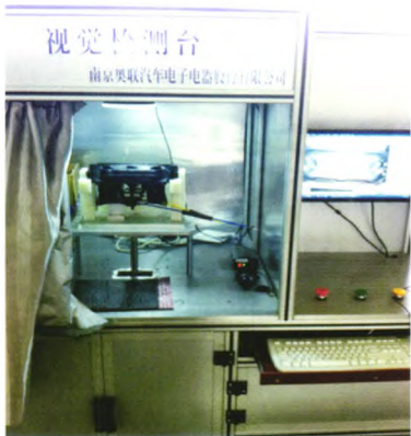
图1 检测工作在暗箱中进行
