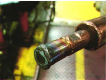
图4 焊接镀锌板产生的蘑菇状电极
