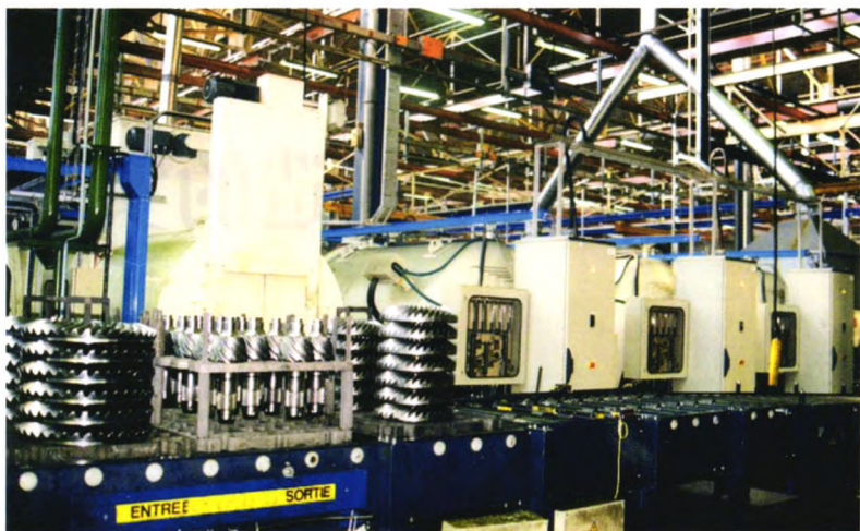
连续式低压真空渗碳自动生产线
