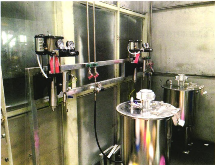
图2 气动高压柱塞泵及搅拌桶
