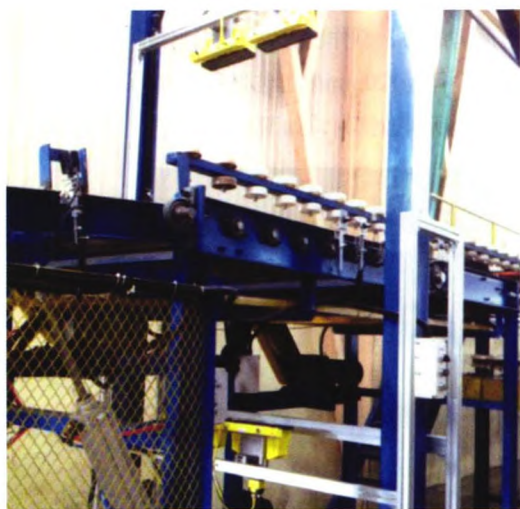
安装在轨道下方读码器
