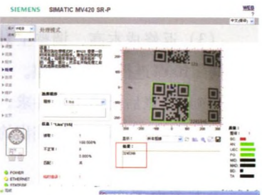
图17 MV420读码结果“3245346”
