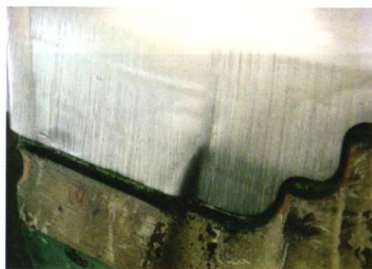
图12 侧围外板局部变形
