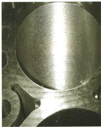
图8 缸孔表面螺旋纹
